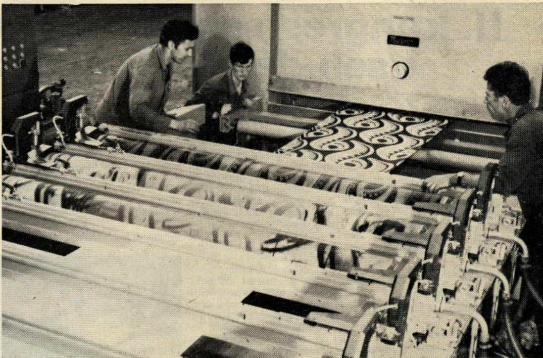
Prvi poskusni metri na novomontiranem razpenjalno sušilnem stroju
