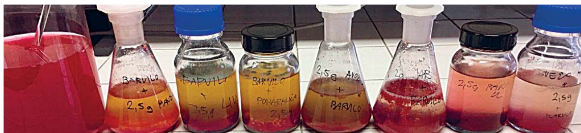
Slika 3: Od leve proti desni: izhodiščno onesnažena odpadna voda z barvilom, odpadne vode, očiščene z mandarininimi, limoninimi, pomarančnimi, avokadovimi, jabolčnimi in bananinimi olupki in z nesušeno (svežo) banano
