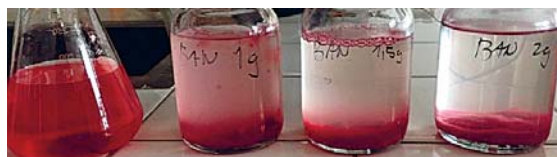
Slika 2: Izhodiščna odpadna voda, onesnažena z barvilom, in odpadne vode, čiščene s sušeno banano v koncentracijah 5, 7,5 in 10 g/l
