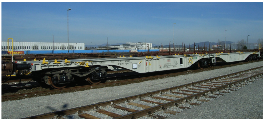
Tovorni vagon tipa SGMRS 90' v kontejnerskem terminalu Ljubljana - Zalog
