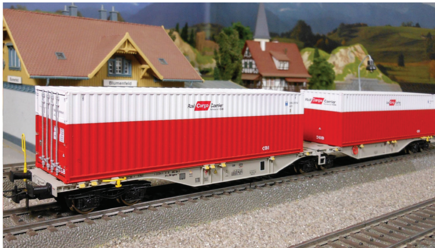
Mehanov dvodelni kontejnerski vagon SGMRS 90' železniškega operaterja ÖBB z dvema kontejnerjema 40' družbe Rail Cargo Carrier v velikosti H0
