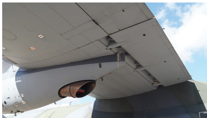
Zadnji del motorske gondole in zakrilca (Foto: Aviamagazine.com)
