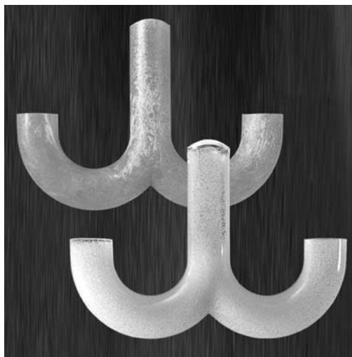
Slika 4: Velike razlike med strukturama površine na primeru dvojnega kavljia iz PC, izdelanega s klasičnim postopkom MuCell (zadaj) in postopkom protitlačnega delovanja plina (spredaj); v obeh primerih je gostota zmanjšana za 6 % [2].
