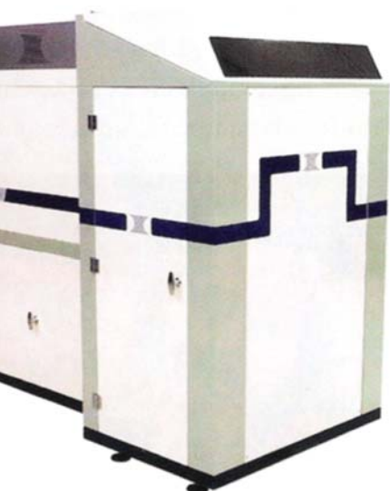
Z infrardečo svetlobo: Oporne konstrukcije Speedpart RP3 ne potrebuje. Pri volumnu 300 mm x 210 mm x 500 mm in točnosti 0,1 mm doseže naprava 20 do 35 mm na uro.
