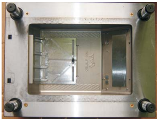
Slika 7: Spodnji del jeklenega produkcijskega orodja
