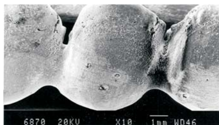
Slika 3: Mikroskopski posnetek zunanje površine odlitih zob
