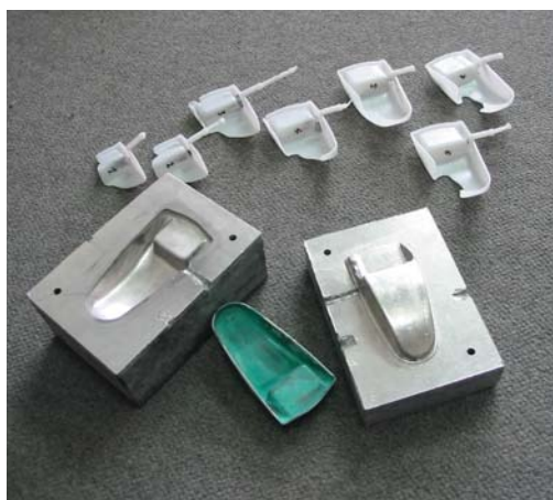
Slika 2. Izdelava orodij s pršenjem kovine na TUCN
