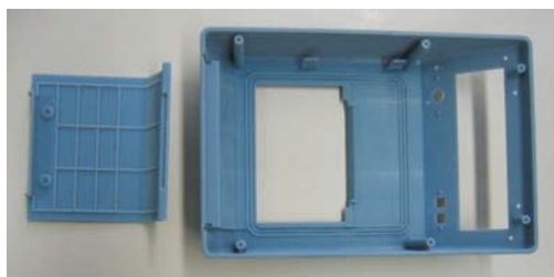
Slika 4: Prototip ohišja, izdelan s postopkom hitre izdelave prototipov PolyJet™
