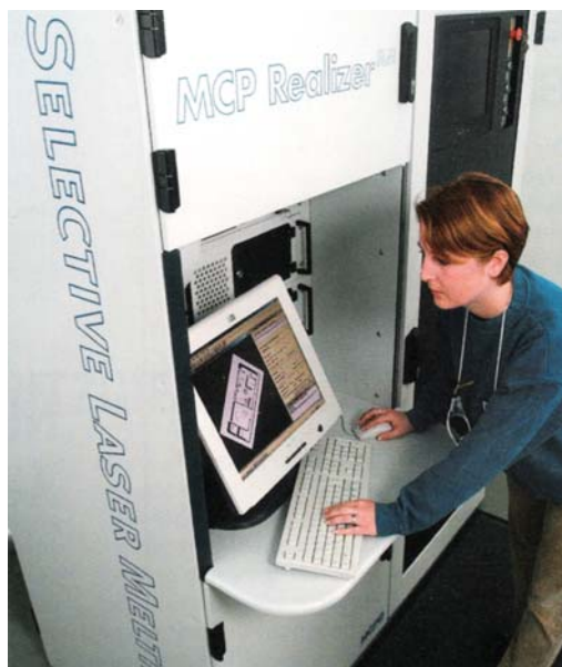
Izdelava implantata z napravo MCP Realizer II SLM
