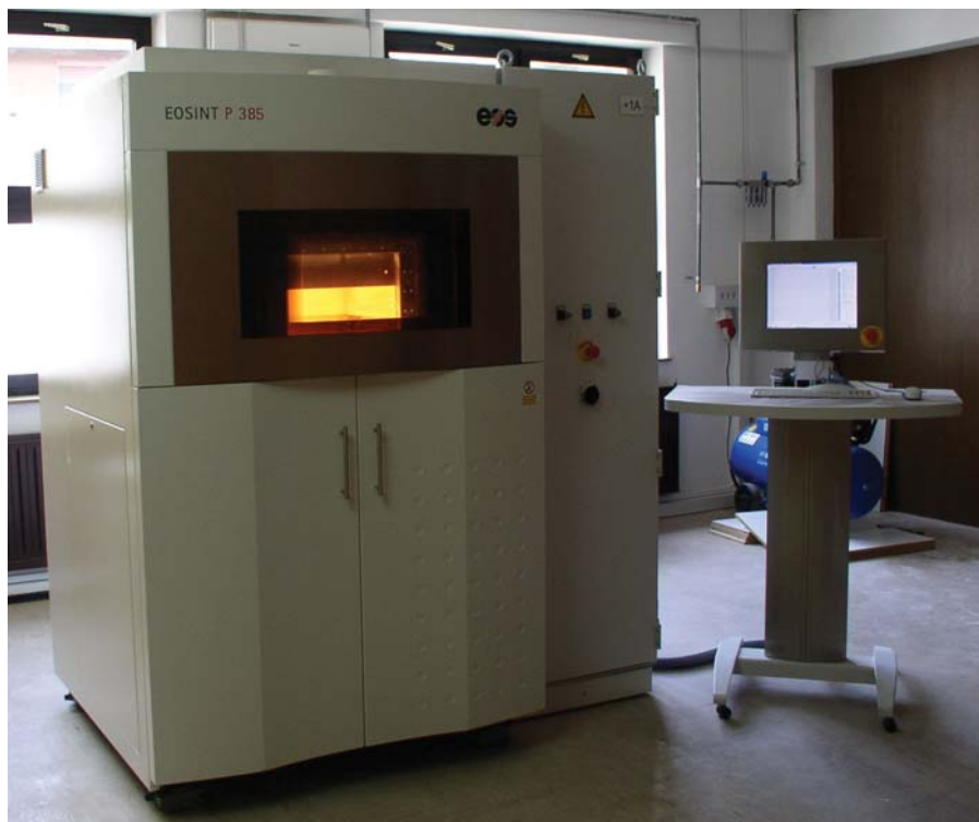
Stroj za lasersko sintranje plastičnih prahov je nova pridobitev v RTCZ, d. o. o.
