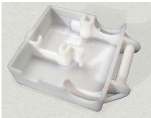
Slika 2: Spodnji del ohišja baterije, izdelan s tiskalnikom Dimension SST
