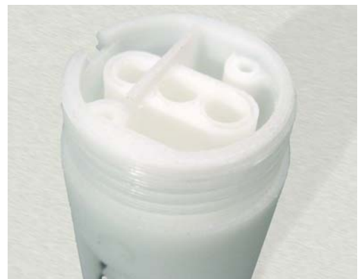
Slika 3: Osnova grla, izdelana s tiskalnikom Dimension SST
