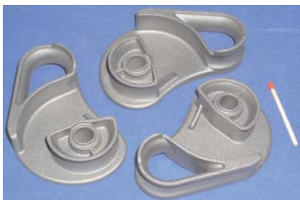
Slika 4. Nekateri primeri RM-izdelkov, narejenih z laserskim sintranjem (vir RTCZ in EOS).
