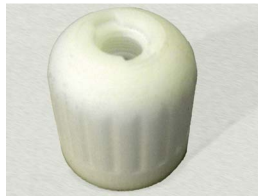
Slika 4: Pokrov grla, izdelan s tiskalnikom ZPrinter 310
