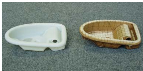
Slika 5. Jedro, izdelano po LOM-postopku za hitro izdelavo orodij na TUCN
