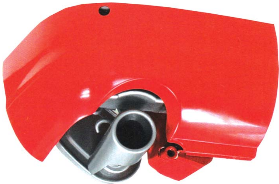
Lasersko sintran del odbijača Jaguarja XJ. Lakiran model so uporabili za predstavitev med pripravo proizvodnje.
