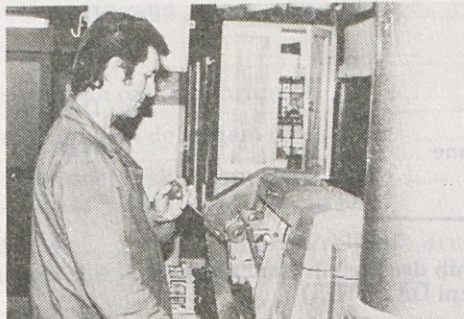
Brušenje gumi valjčkov za predilne stroje »TEKSTIMA«.
