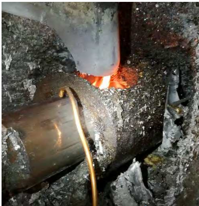
Slika 3. Premer bata 130 mm: doziranje v livno komoro
