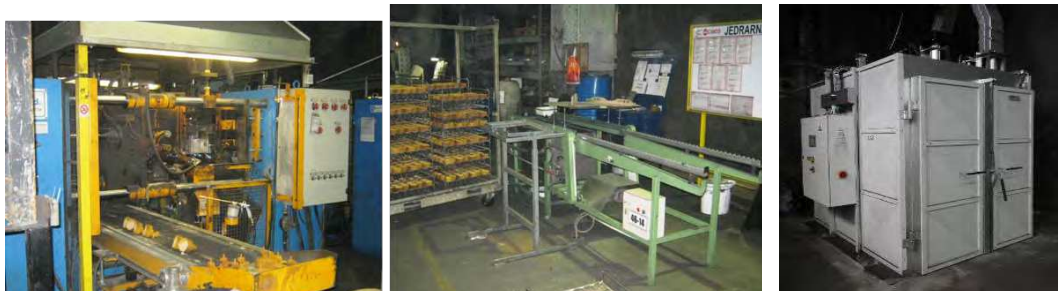
Izdelava Croning jeder, premazovanje in sušenje premazanih jeder
