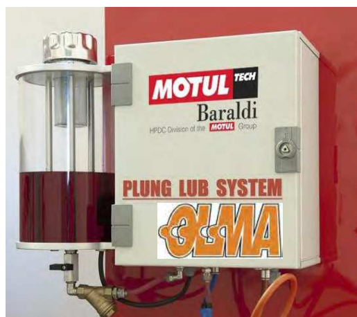
Slika 2. Mazalna naprava z volumetričnim doziranjem
