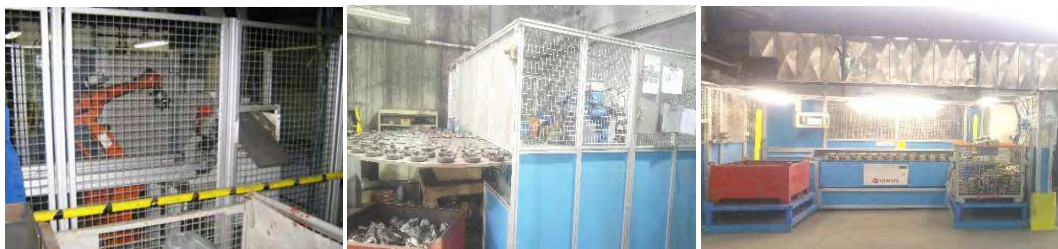
Brusilni roboti za centralna ohišja turbokompresorjev (ABB, Motoman, Yaskawa)
