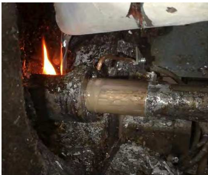
Slika 5. Premer bata 60 mm: doziranje v livno komoro
