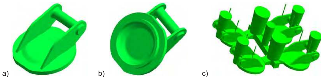
Slika 7-1. Tridimenzionalna skica ulitka pokrova škatle in skupine za litje; a) Prednji del ulitka pokrova škatle ulitka, b) Spodnja površina kasete, c) Skupine za litje pokrovov škatle
