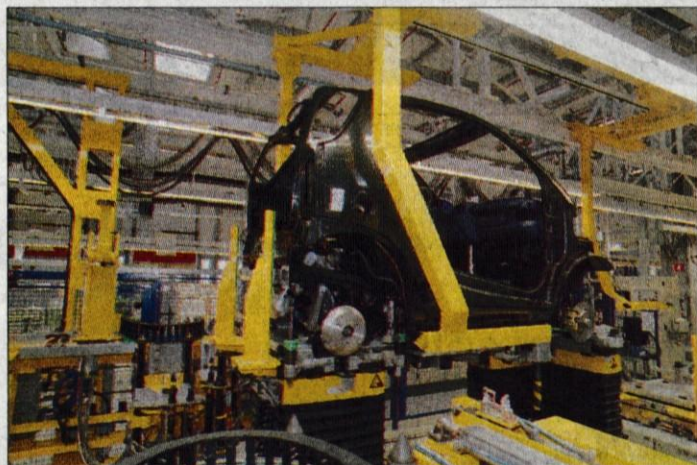
Pritrjevanje plastičnih delov karoserije, ki jih izdeluje dobavitelj Dynamit, Nobel je že del zaključne montaže.
