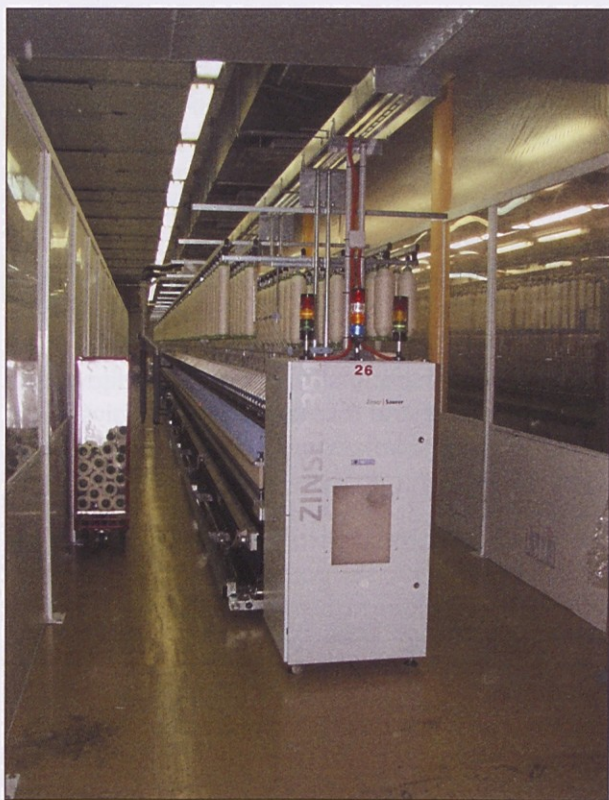
Prstančni predilni stroj Zinser RM 351
