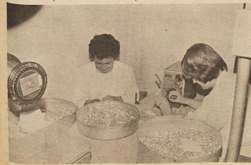
Zdenka Dragan in Ema Kastelic pri ultrazvočnem varjenju katodnih odcipov na ohišje.
