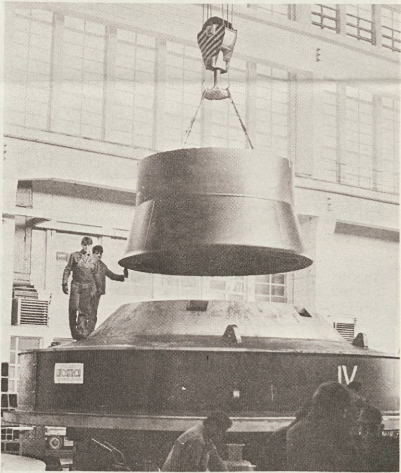
Končna montaža četrtega turbinskega pokrova za HE Haditha (Foto: E. L.)
