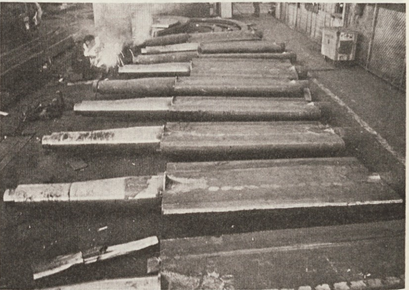
Vodilne lopate za šesto serijo za HE Haditha pred defektoskopsko kontrolo (Foto: T. Š.)
