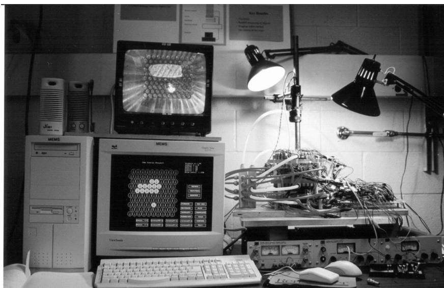
Sl. 2. Celoten sistem naprave s pnevmatično aktivno površino Fig. 2. The complete system of the pneumatic active-surface device
