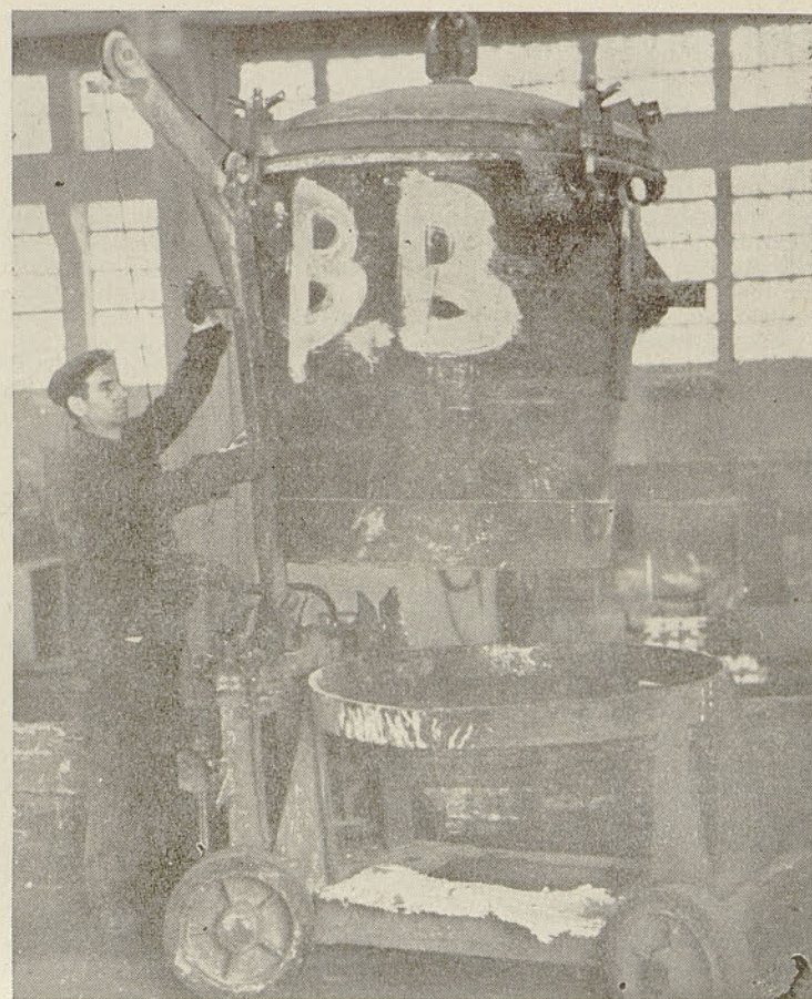
Nameščanje praznega vakuumskega lonca za črpanje aluminija na voziček
