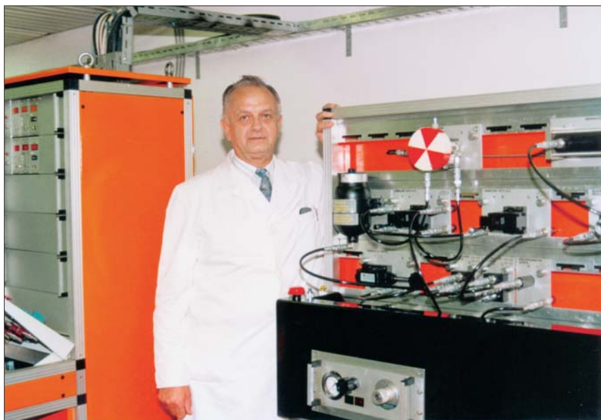
Sistem učnih pripomočkov za hidravliko SUPH-1 – prototip na FS v laboratoriju za fluidno tehniko
