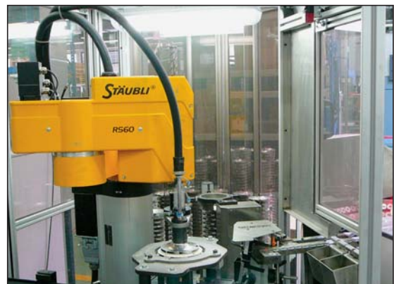
Slika 1. Avtomatizirana celica za sestavo turbinskega kolesa sesalne enote RS 60
