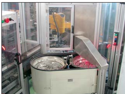
Slika 2. Urejanje, dodajanje in nadzor s strojnim vidom
