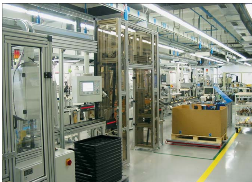
Sledenje podatkov o vseh vgrajenih sestavnih delih po serijskih številkah oz. šaržah pri proizvodnji elektromotorja za pomoč vrtenja volanskega droga pri Oplu Corsi
