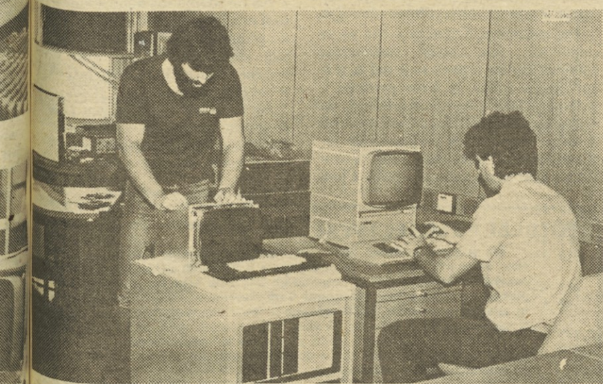
V razvojnem laboratoriju preizkušajo prototip večuporabniškega mikroračunalniškega sistema ID 80—76.
