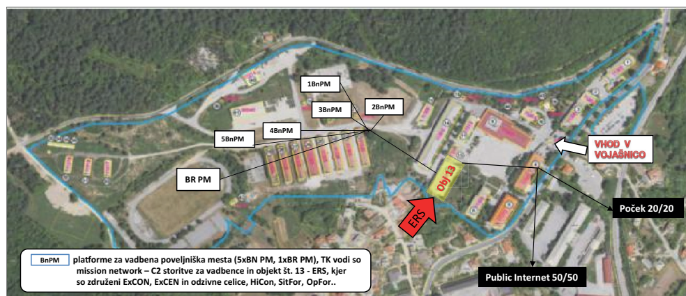
Slika 3: Shema TK-vodov v postojnski vojašnici, januar 2016
