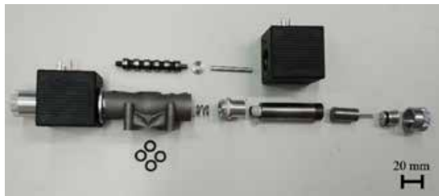
Slika 4 : Polovično sestavljen obravnavan potni ventil (258 mm x 55 mm x 45 mm)
