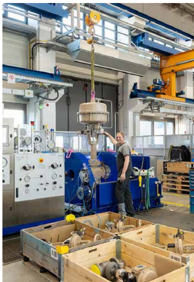
Slika prikazuje končni prevzemni test v oddelku montaže ventilov podjetja SAMSON v Frankfurtu.
