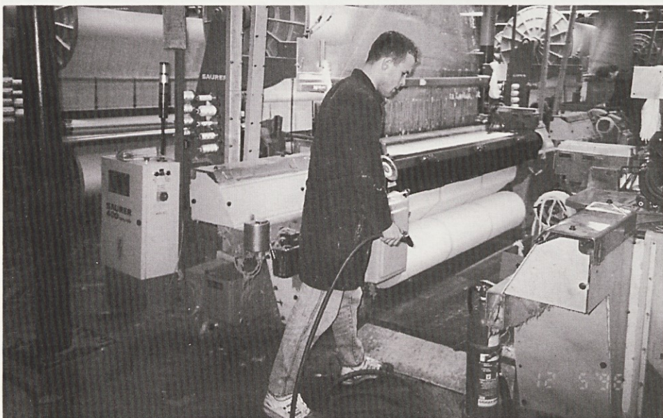
Po sanaciji tkalskega stroja, na katerem je izbruhnil požar
