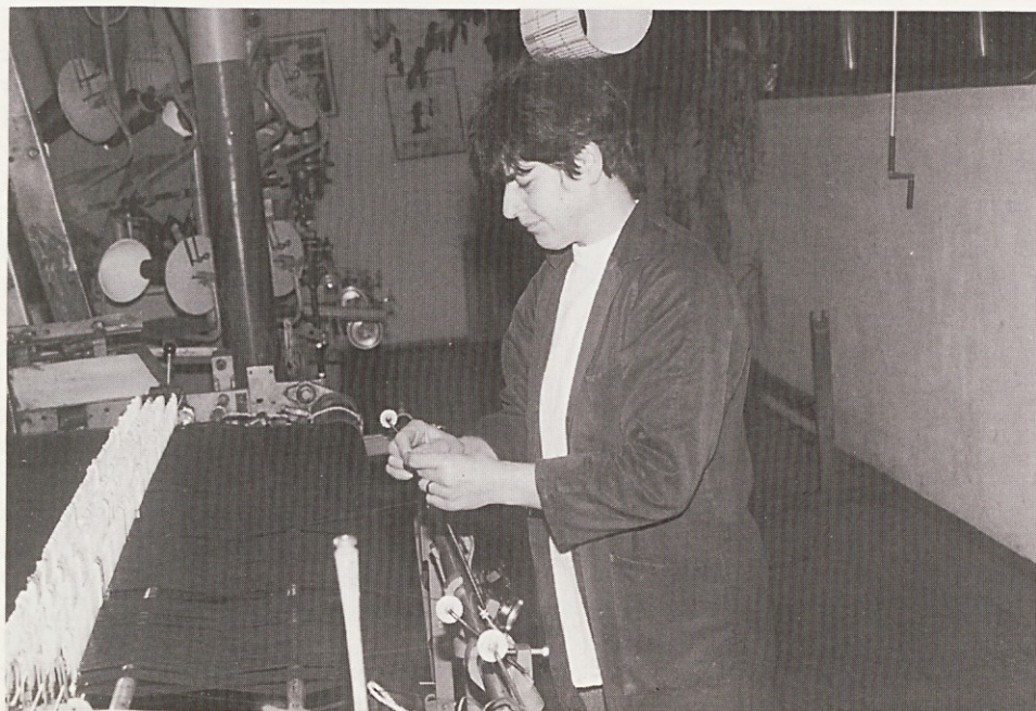
V tkalnici svile pri likvidaciji pretrga pri izdelavi rut
