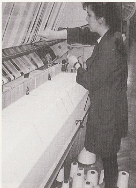
Odpravljanje pretrga na tkalskem stroju
