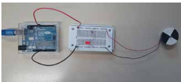
Slika 21: Vezje za prikaz učinka spreminjanja efektivne napetosti na digitalnem izhodu s pomočjo PWM (modulacije širine pulza) na izsev rdeče LED in na hitrost vrtenja elektromotorja.
