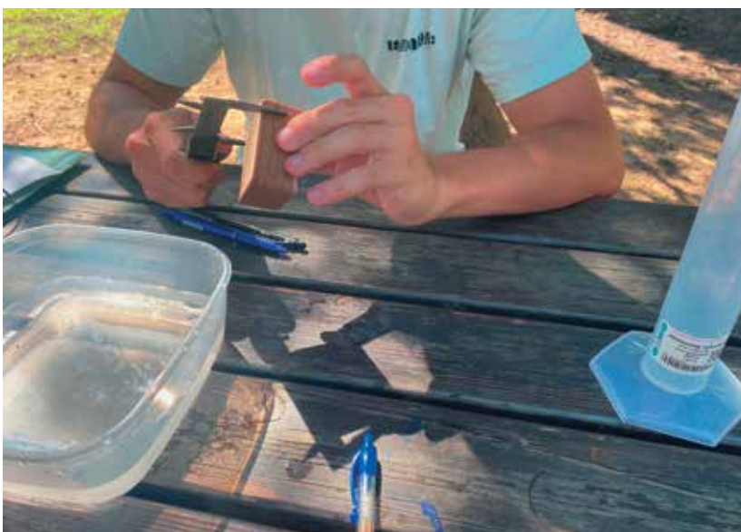
Slika 10: Merjenje s kljunastim merilom.
