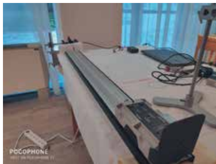
Slika 10: Otok 4 – preizkušanje opreme, ki jo je prinesla ena od udeleženk: voziček, svetlobna vrata in škripec, ki prekinja svetlobni curek.
