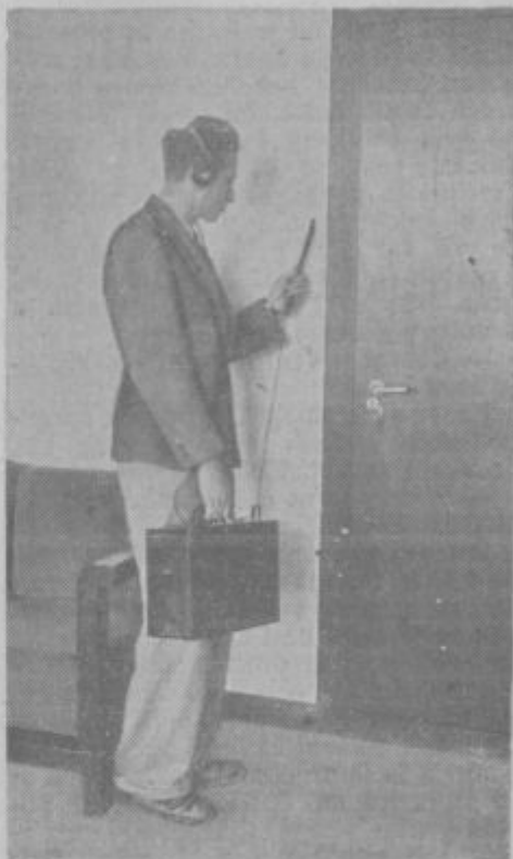
Aparat za iskanje motenj s tipalno anteno, s katero se preiščejo vsi sumljivi deli električnih aparatov
