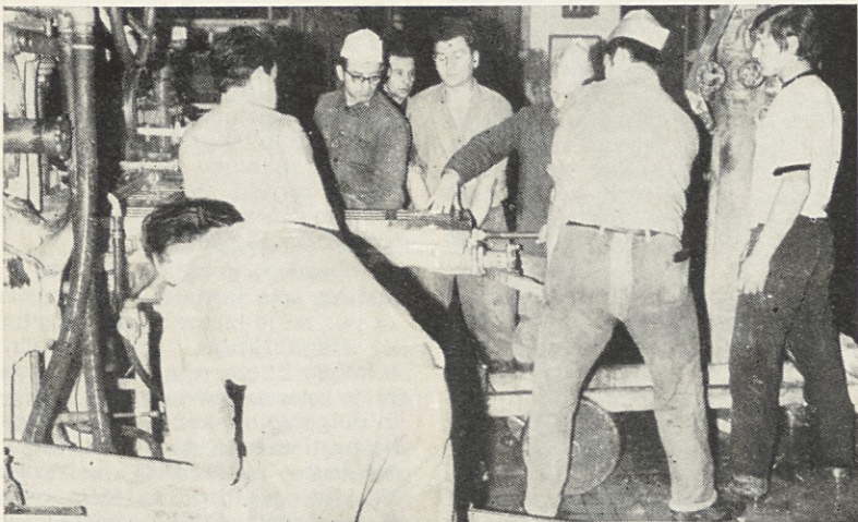
Ekipo II. PS pri menjavi sesalnih omar ob dnevnih redne reparature strojev
