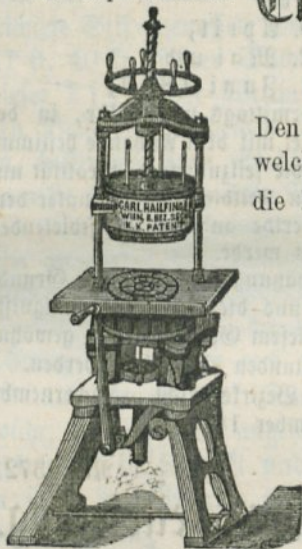
Teigtheilungs- od. Aufgebmaschine für Bäcker.
