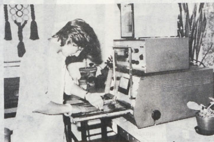
Najpomembnejša podatka za predilca sta prav gotovo dolžina vlaken in mikronaža (debelina vlaken). Ugotavljamo ju na aparatih ALMETER in AIRFLOW .
