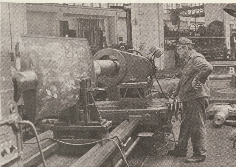
Obdelava ene izmed vodilnih lopat za HE Mostar — tretja serija.
