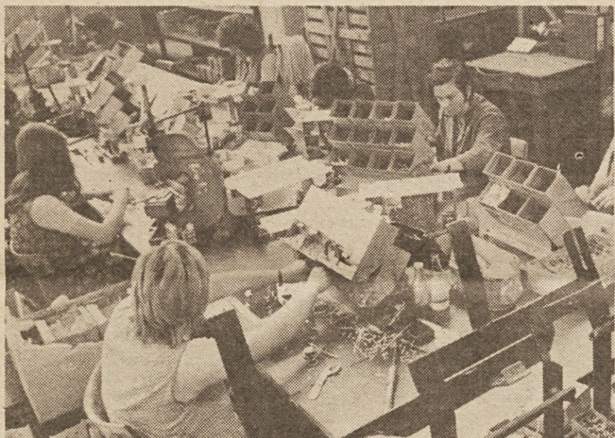
Mehanski trak — v okvirni montaži radijskih sprejemnikov.
