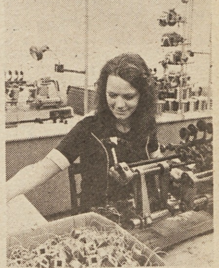
Danica Skrlj navija tuljave na stroju AUTIAN.
