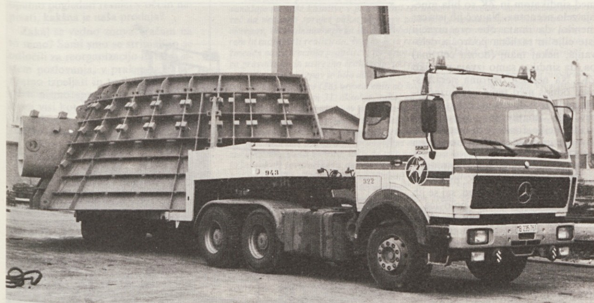
Polovica prvega od treh predvodilnikov za HE Vrhuvo je bila odposlana iz podjetja koncem oktobra. Dela za HE Vrhuvo so se v Litostroju zaradi neplačanih obveznosti s strani investitorja zaustavila za približno tri mesece, vendar pa v tem trenutku že poteka montaža predvodilnika na gradbišču. Montažo izvaja Hidromontaža iz Maribora pod strokovnim vodstvom našega strokovnjaka Marjana Pihlerja. (Foto: B. Francelj)
