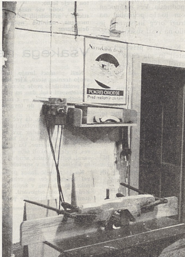
Ker ni bilo zaščite, ki jo vidite na sliki, je stroj poškodoval delavcu prste
