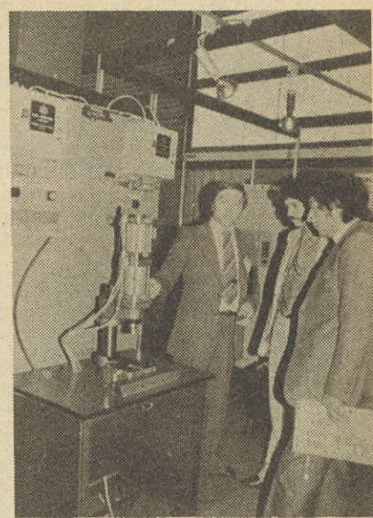
Dvoročna vklopna naprava za vklopjanje stiskalnic.
