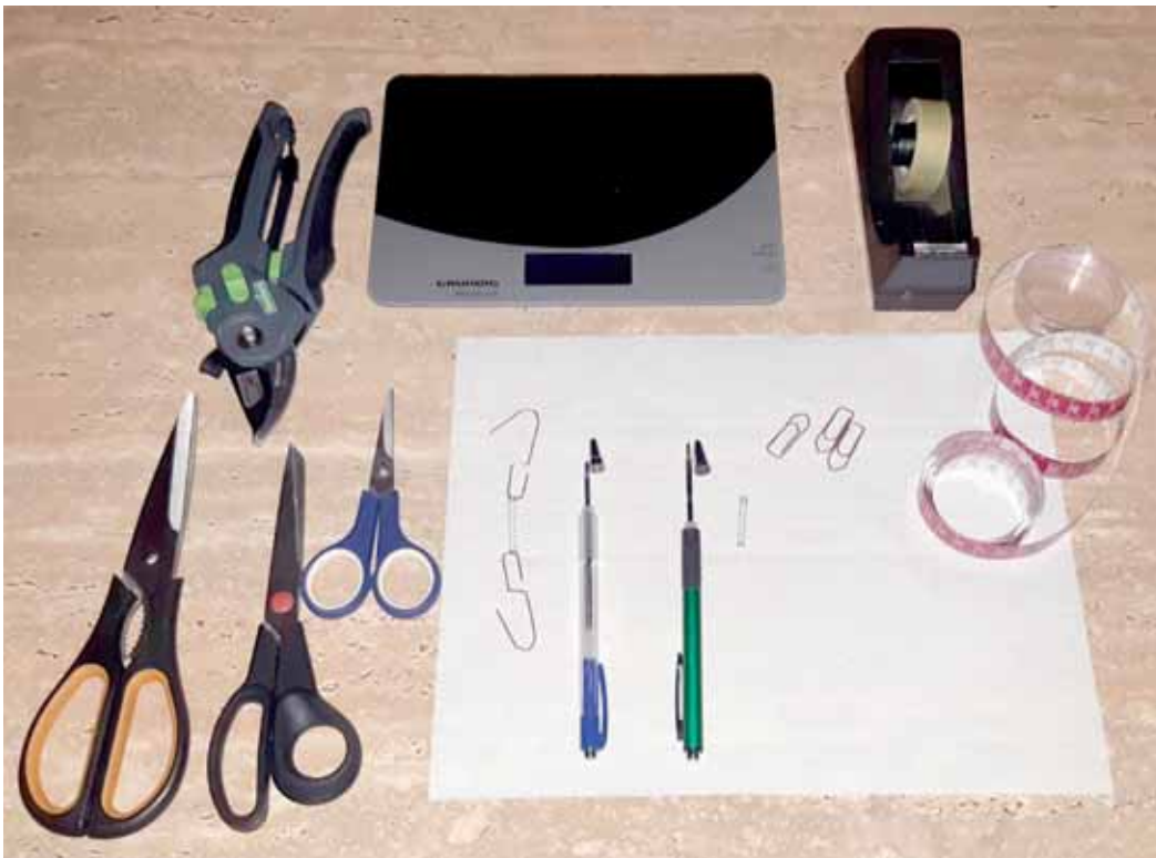
Slika 4: Mogoči nabor opreme za merjenje konstante vzmeti. Iz sponk za papir naredimo kavljce, različne škarije služijo kot različne uteži.
