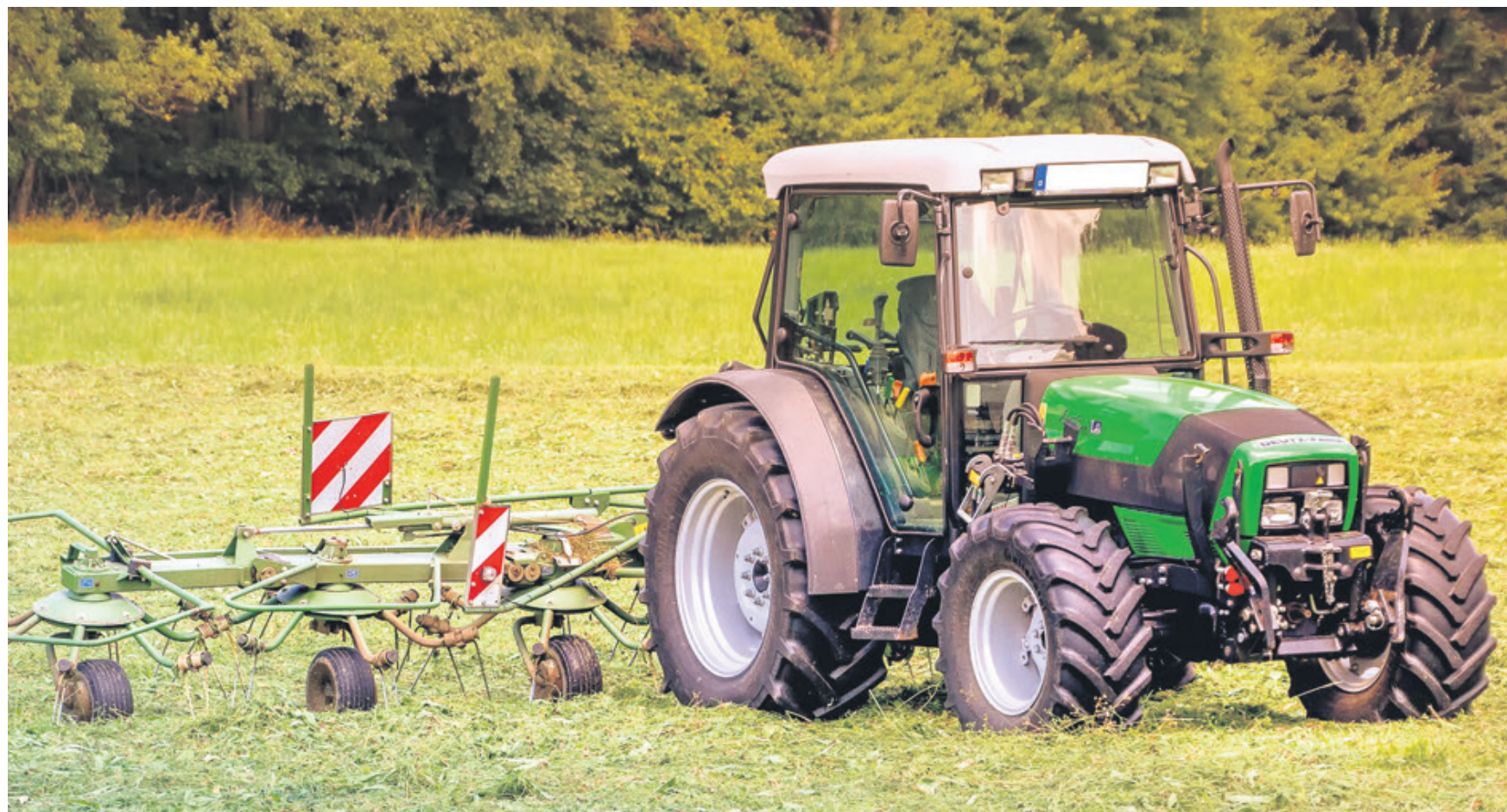
K večji varnosti pri uporabi traktorjev je po besedah sogovornika prispevalo tudi zakonsko določilo, ki določa, da mora imeti vsak traktor varnostno kabino ali varnostni lok. »Če vozilo tega nima, so ob nesrečah s prevrnitvijo možni zelo slabi izidi.« (Foto: Pixabay)
