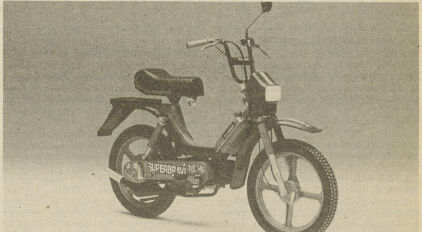
Superbravo 3 je novo Piaggiovo motorno kolo, namenjeno mladim, predvsem tistim izpod 16 let. Težko je 57 kg, poganja ga dvotaktni 49-kubični motor, glavna značilnost pa je, da ima tristopenjski menjalnik
