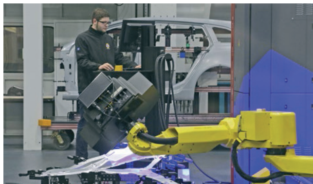
» Celotna merilna procedura na merilnem stroju ATOS ScanBox lahko nadzira proizvodni delavci z uporabo poenostavljenega uporabniškega vmesnika. Vir: GOM
