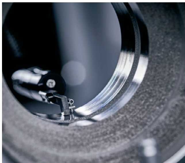
» Programsko nadzorovano merjenje površinske hrapavosti izvira merjenje z ročnimi napravami. Vir: Renishaw
