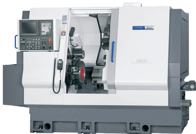
» Obdelovalni stroj Miyano BNE-51MSY. Serija strojev BNE je znana po svoji visoki togosti, dobri učinkovitosti odrezovanja in izjemni natančnosti obdelave. Vir: Citizen
