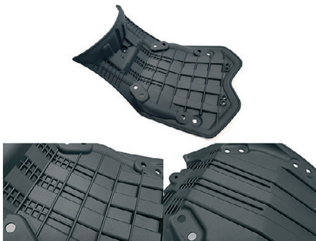
» Slika 5: 3D-tiskani funkcionalni prototip sedežne oporne plošče z dodatnimi rebrastimi strukturami (material: Windform GT).
