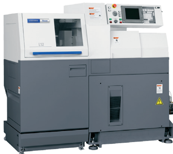
» Obdelovalni stroj Cincom L12-VII je zelo primeren za 7-osno obdelavo majhnih izdelkov. Vir: Citizen
