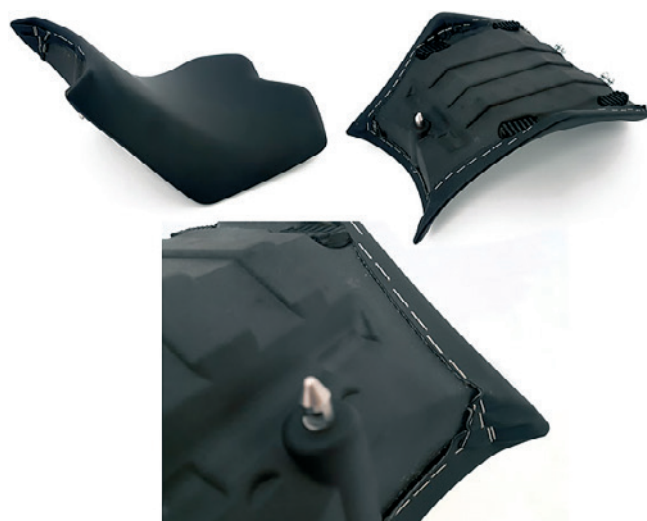
» Slika 4: Funkcionalen prototip Energica Ego 3D (pokrit). Podrobnosti pritrditve s sponkami.
