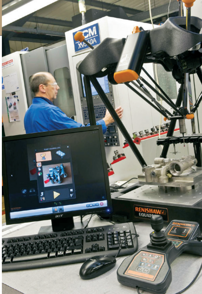
» Podjetje FGP uporablja vsestranski merilni sistem Renishaw Equator » za hitro kontrolo dimenzij v delavnici.
