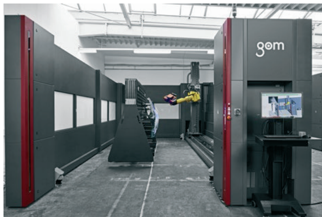
» 3D-optični koordinatni merilni stroj ATOS ScanBox 7260 proizvajalca GOM za merjenje velikih izdelkov. Vir: GOM
