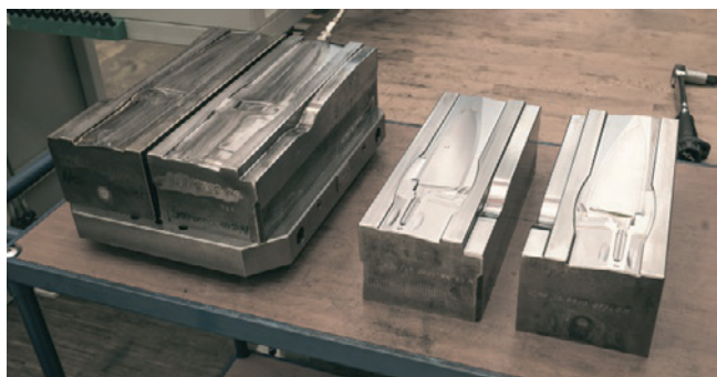
» Kovani utop (zgornji in spodnji del orodja), ki je levo brez prilagoditvene plošče vpet neposredno na paleti in pritrjen z dvema zatičema ter s pomočjo štirih vijakov; desno pa so prikazani štirje obdelani utopi. Vir: WMF Group
