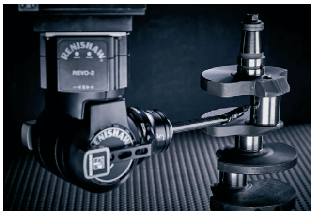
» Merilna glava Revo-2 z naprednim tipalom za merjenje hrapavosti SFP2 proizvajalca Renishaw. Vir: Renishaw
