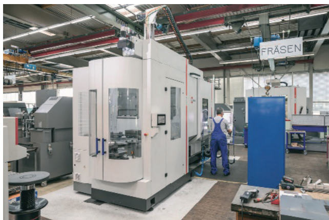
» Izmenjevalnik palet PW 150 stroja obdelovalnega centra C 22 UP; v ospredju je (vrtljivo) mesto za opremljanje palet/sprejemnih nastavkov za obdelovance z obdelovanci oz. za odstranjevanje gotovih delov. Vir: WMF Group
