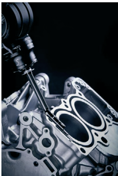
» Prednosti uporabe 5-osnega skeniranja na koordinatnem merilnem stroju (CMM) v primerjavi s sistemi z le tremi linearnimi osmi. Vir: Renishaw
