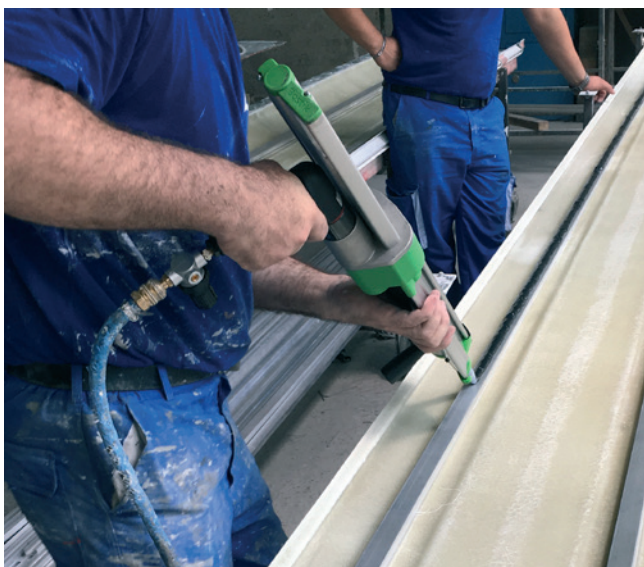
» Lepljenje alu profilov na armiran poliester.
