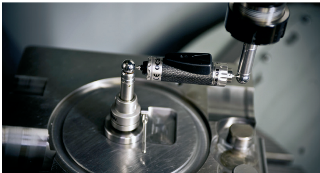
» Brežični ballbar Renishaw QC20-W med kontrolo natančnosti petosnega CNC-obdelovalnega stroja
