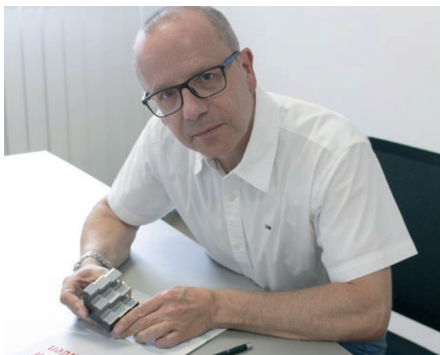
» Ulrich Seifferth z orodnim vložkom, ki je uporabljen za brizganje plastike. Izdelava takega vložka zahteva najvišjo raven natančnosti obdelave, saj v nasprotnem primeru geometrija odstopa od nominalne vrednosti predpisanih dimenzij. Vir: GOM
