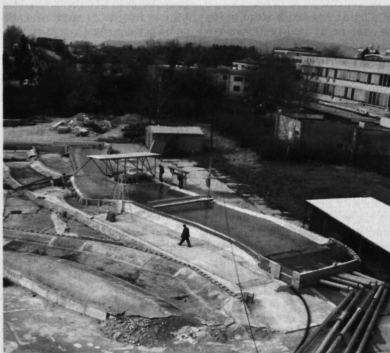
Pogled na ploščad oziroma na poligon pred inštitutom. Levo spodaj je model za HE Vrhovo, ki ga že odstranjujejo in pripravljajo prostor za model HE Krško, na sredi model HE Boštanj, na desni pa model HE Blanca, na katerem trenutno potekajo raziskave.
