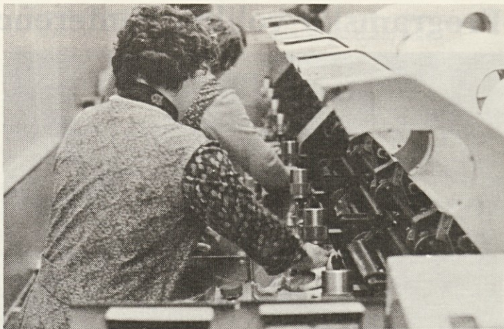
Redno čiščenje česalnih strojev, ki ga opravljajo delavke in delavci čistilne kolone. Vsak ponedeljek temeljito očistijo po enega od šestih česalnih strojev, namažejo in odpravijo morebitne drobne okvare. Tako pride vsak stroj na vrsto za veliko čiščenje vsakih šest tednov. Za sprotno čiščenje pa poskrbijo posluževalke teh strojev.
