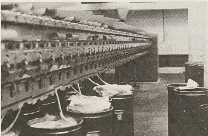
V proizvodnji moramo večkrat opraviti poskusno predenje novih materialov, kar nam je potem v pomoč pri odločanju za redno proizvodnjo. Na sliki — poskusno predenje finejših celuloznih vlaken na OE stroju.
