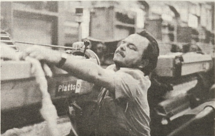
Posluževalec mikalnikov sproti čisti svoje stroje. Na sliki Avgust Požun.
