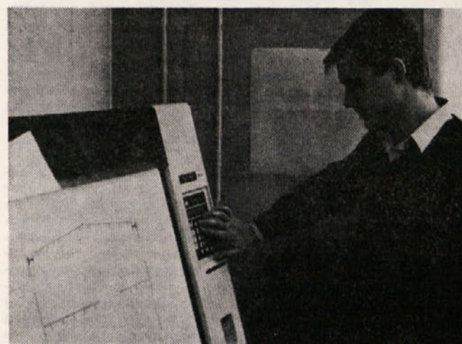
Naš projektant Dušan Štiherl, dipl. gradb. inž. pri ploterju (risalniku), ki opravlja izris načrtov, izdelanih s pomočjo računalnika
