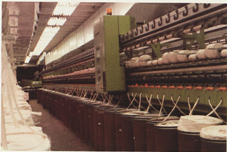
Stroji, ki so začeli obratovati v tednu, ko smo praznovali naš jubilej. Zgoraj — avtomatska odzematnica bal — Hergeth (Optomix) in Rieter (Unifloc), desno — avtomatski rotorski predilnik Ingolstadt.
