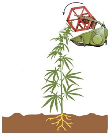
Slika 10: Kosilni greben in motovilo na primerni višini.
