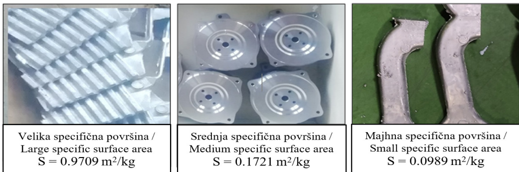
Slika 7. Krožni material z različnimi specifičnimi površinami: LSS – velika specifična površina, MSS – srednja specifična površina in SSS – majhna specifična površina 20
