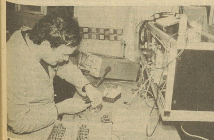
Funkcijsko testiranje tiskanih vezij v končni kontroli
