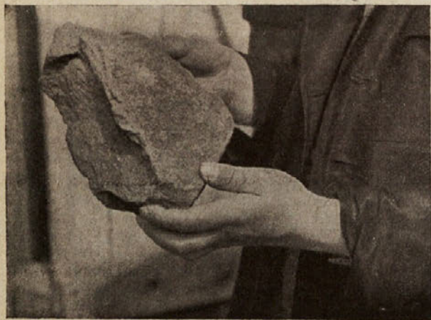
Gruda naftovega škrljevca (iz 2 kg škrljevca pridobe okoli 500 g tekočega goriva).
