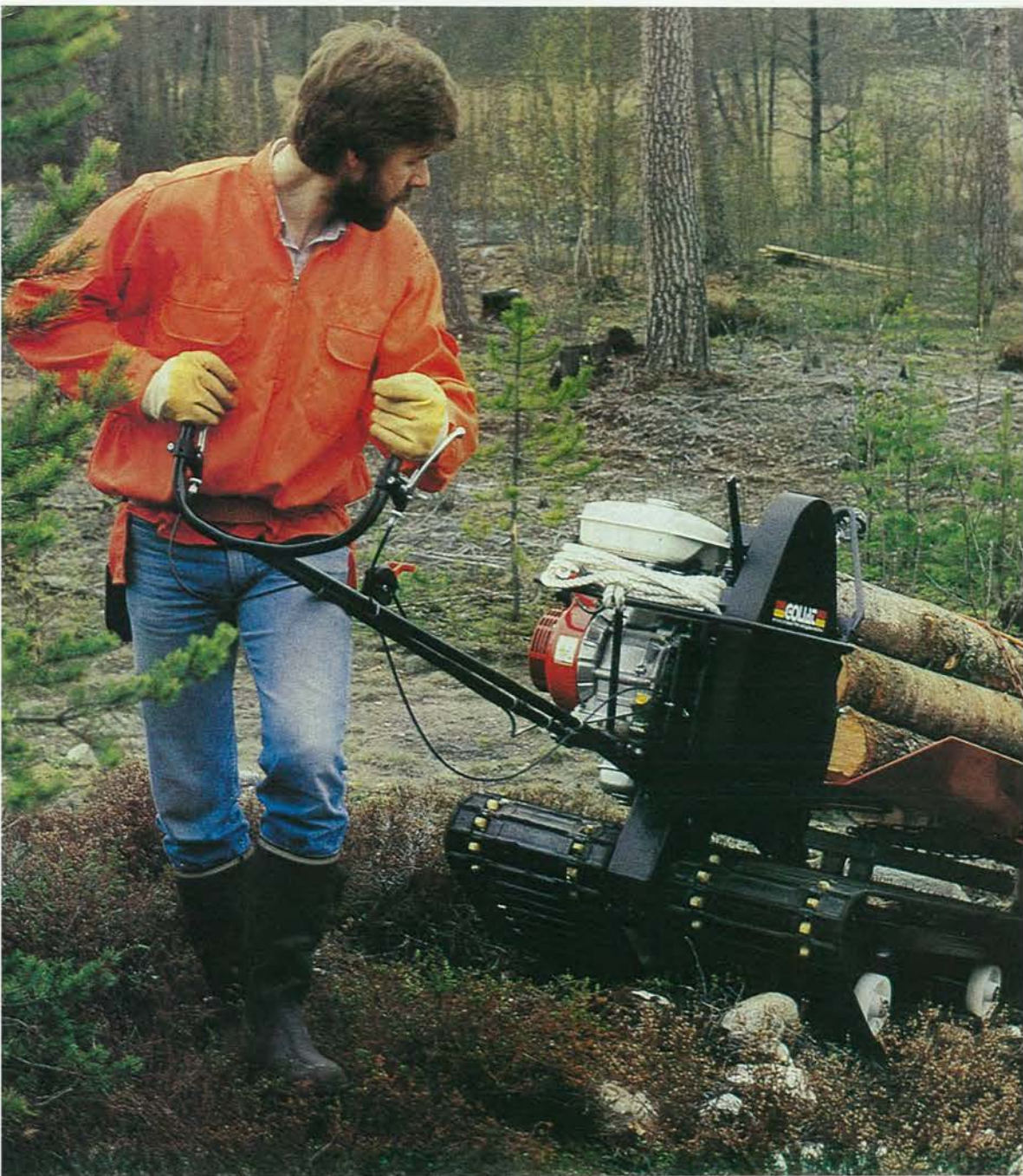
Ročni traktor z gumijastimi gosenicami je zlasti za spravilo lesa iz drogovnjakov hvaležen pripomoček.
