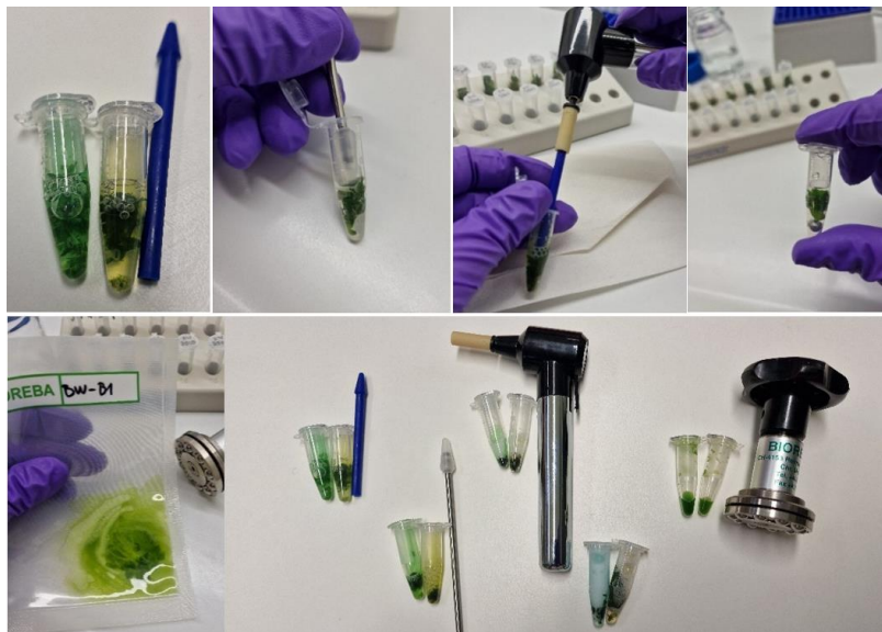
Slika 3: Različni homogenizatorji od leve proti desni. Plastično in kovinsko pestilo, baterijski homogenizator, kovinska kroglica, ročni homogenizator z Bioreba vrečko. Prikaz homogenizacije z različnimi pestili in končnega homogenata listov hmelja v pufrih GEB3 in GEB4.
