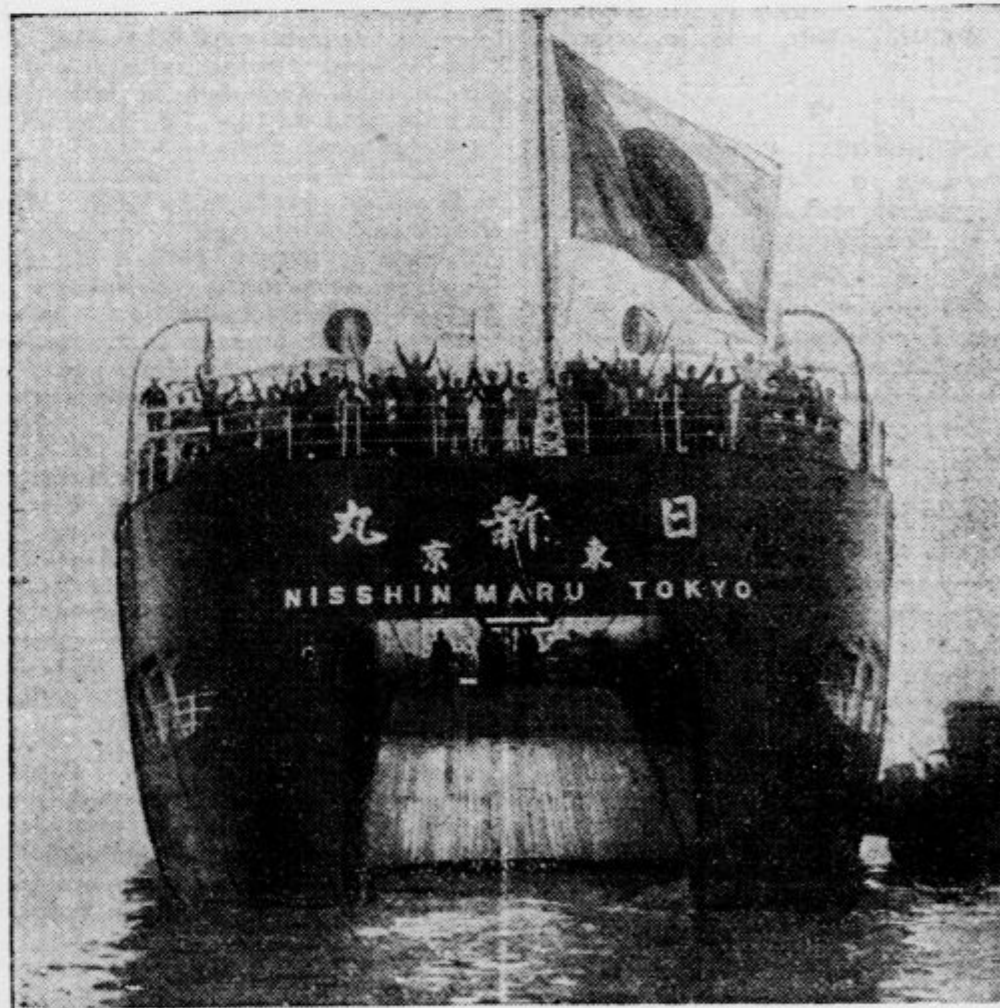
Japonci so zgradili največji parnik za lov na kite, 22.000-tonski »Nisshin-Marus«. Tu ga vidimo v kobejskem pristanišču od zadaj, kjer ima veliko odprtino, skozi katero spravljajo ogromne sesalce v notranjost ladje, da jih predelajo
