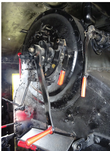
Ročica parnega ravnala na brotanovem kotlu
