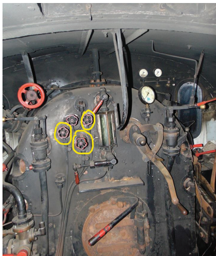
Pipice na klasičnem kotlu lokomotiv JŽ 17 (Foto: Mitja Vaupotič)
