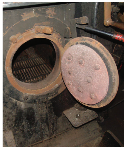
Kurilna vratca na klasičnem kotlu lokomotiv JŽ 17 (Foto: Mitja Vaupotič)
