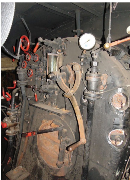
Ročica parnega ravnala na klasičnem kotlu (Foto: Mitja Vaupotič)
