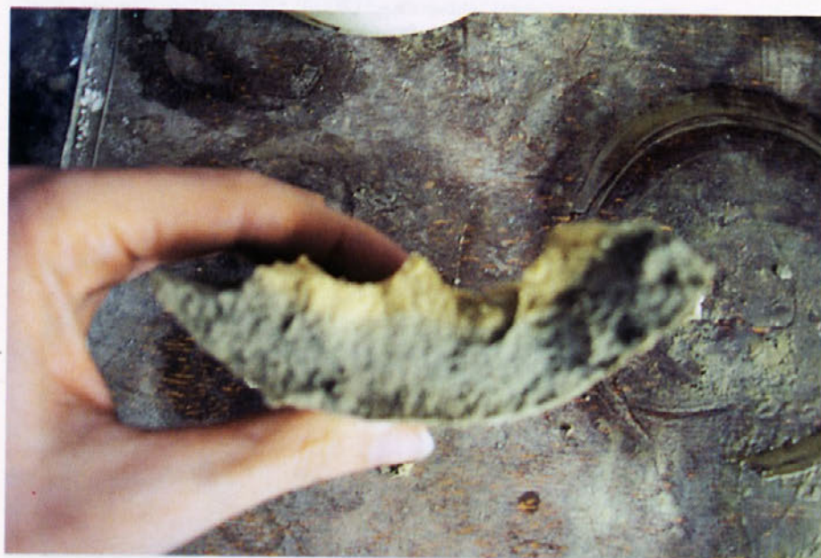
Prez pogače kaže nastalo plast pomožnega filtrirnega sredstva med naplavljanjem ter blato pomešano s pomožnim filtrirnim sredstvom po končani filtraciji.
