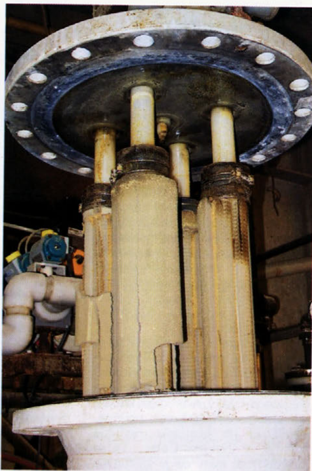
Odprt svečni filter s svojo vsebino po končani filtraciji; pogača še ni v celoti odpadla.
