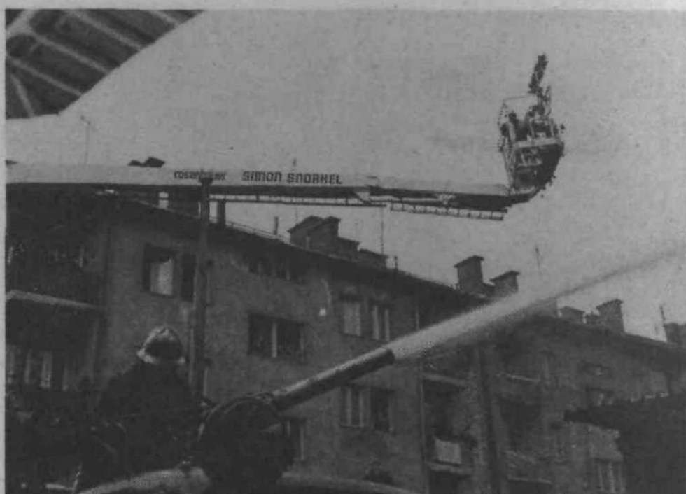
Klasične gasilske lestve niso namenjene reševanju, temveč dostopu gasilcev do ogroženih delov pogorišč. Hidravlično dvigalo, kakršnega vidimo na sliki, pa je namenjeno gašenju, v kritičnih primerih pa tudi reševanju manjšega števila ljudi.
