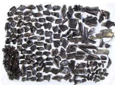
Slika 6. Delci ročne bombe M52 po eksploziji. Vzrok poškodb so delci (fragmenti), ki nastanejo ob eksploziji ročne bombe, ki imajo začetno hitrost ob eksploziji več kot 6000 m/s. Smrtna poškodba lahko povzročijo fragmenti v polmeru 20 m od kraja eksplozije, nevarni pa so lahko tudi na razdalji 100 m in več
