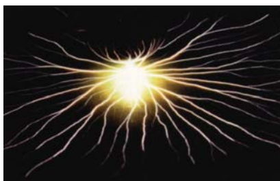
Slika 7. Primer pojava razširjene grmičaste razelektritve
