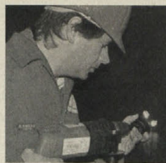
Um den Schadensumfang genau feststellen zu können, müssen Bohr- und Wischproben entnommen werden.
