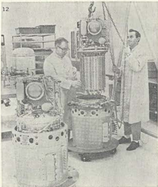
Gorilne celice, glavni povzročitelji zapletov, pri preizkušanju v laboratoriju
