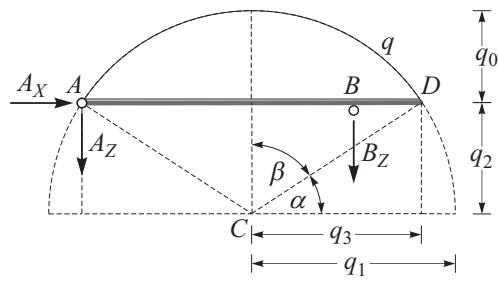
Ploščino krožnega odseka izračunamo tako, da od ploščine krožnega izseka odštejemo ploščino trikotnika  $ACD$ :
