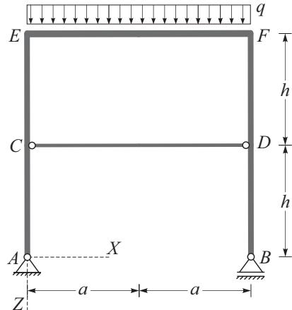
Namig: Osno silo v palici izračunamo z enačbo:  $N = \frac{E A}{L} \Delta L$ .
