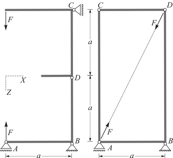
**Rešitev:** Ker sili  $F$  ležita na isti smernici in sta nasprotno usmerjeni so reakcije te prostoležeče konstrukcije vse enake nič, kar lahko preprosto preverimo z zapisom ravnotežnih enačb za celotno konstrukcijo.
