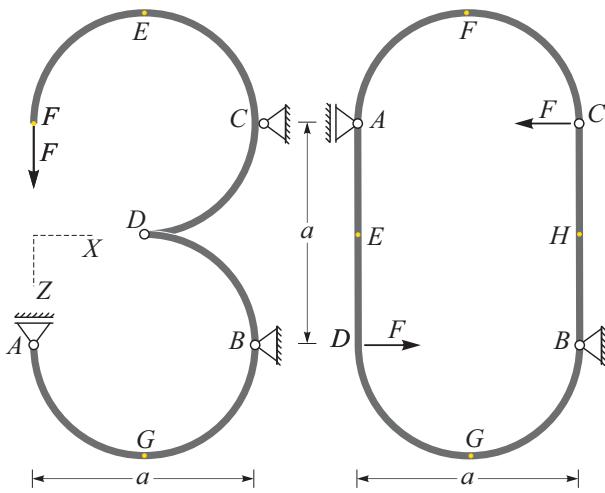
**Rešitev:** Reakcije v podporah  $A$  in  $B$  izračunamo iz ravnotežnih pogojev za celotno konstrukcijo.
