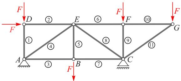
Drugo pravilo pravi, da je v vozlišču s tremi palicami, kjer sta dve na isti smernici, sila v tretji palici enaka nič, če vozlišče v tej smeri ni obteženo. Zato moramo postaviti navpične sile še v vozliščih  $B$  in  $F$ . Če obravnavamo paličje obtežimo, kot je prikazano na zgornji sliki, so vse sile v palicah različne od nič.
