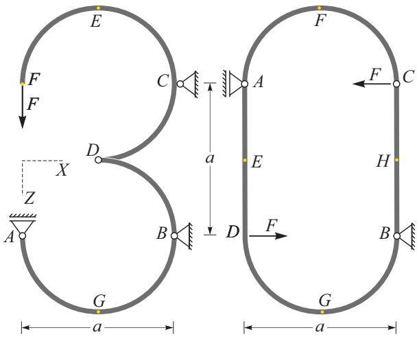
**Rešitev:** Najprej določimo reakcije v podporah  $A_Z, B_X, B_Z, C_X$  in  $C_Z$  iz ustreznih ravnotežnih pogojev. Reakcijo v podpori  $A$  določimo iz momentnega ravnotežnega pogoja glede na vozlišče  $B$  za del konstrukcije  $AB$ :
